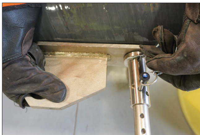
Figure 10c : Insertion de la goupille à dégagement rapide avec le collier de retenue serré à la plaque d'assemblage
