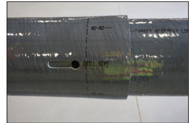
Figure 16c : Trou pour écrou borgne percé
