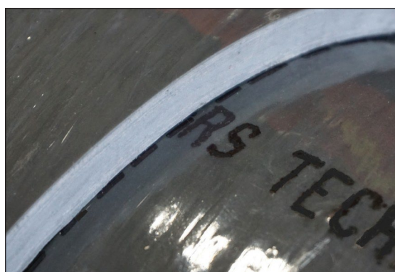
Figure 15 : Exemple d'un joint coulissant assemblé à la ligne de montage cible circonférentielle prémarquée
