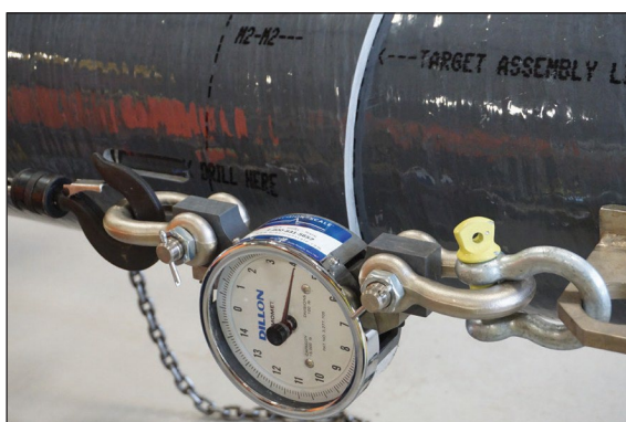
Figure 14 : Joint coulissant terminé, assemblé à 4 000 lb [1 814 kg] de force
